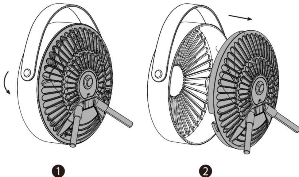
Reinigen Sie die Ventilatorblätter mit einem weichen, trockenen Tuch und schließen Sie dann das Gitter, indem Sie es im Uhrzeigersinn drehen:
